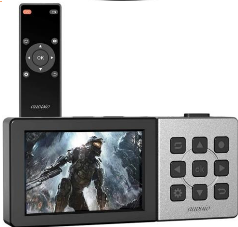
auvisio HDMI Recorder: HDMI-Video-Rekorder mit Farb-Display, Full HD, 60 Bilder/Sek, microSD (Video Digitalisierer)
